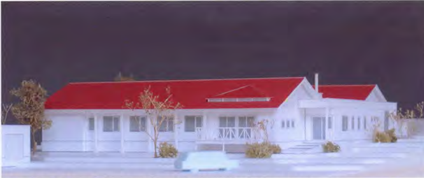
簾舞は雪が多い 軒下には列柱を配置、軒の出寸法を大きく確保している
